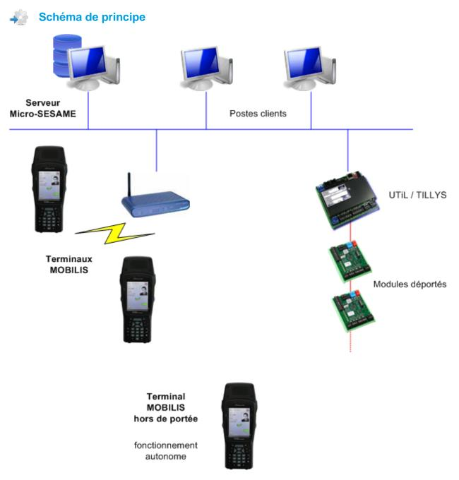
Ce schéma présente le MOBILIS dans un environnement Micro-SESAME. Les terminaux sont reliés au réseau IP (comme une UTL) à travers un point d'accès WiFi. Le terminal hors de portée continue à fonctionner en mode autonome.
